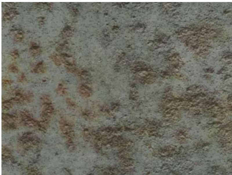
Preparation grades. Blast cleaning D Sa 2
