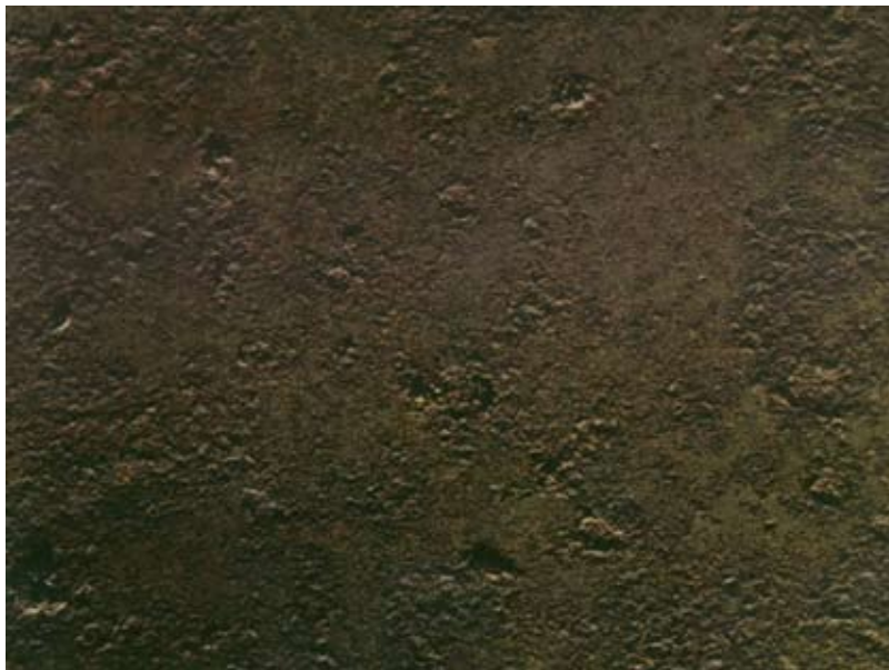
Preparation grades. Blast cleaning D Sa 1
